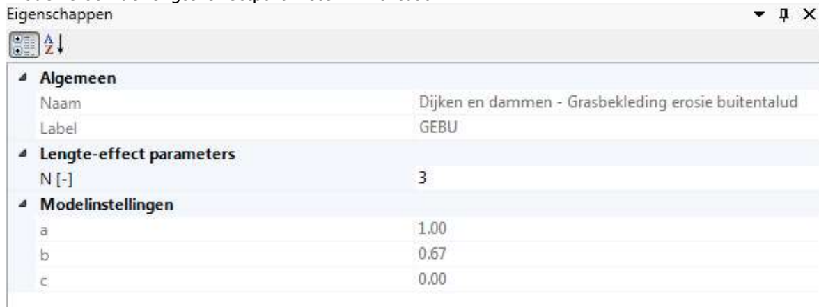
Figuur F.12 Riskeer lengte effectparameter N (-) Erosie grasbekleding buitentalud en modelinstellingen a,b en c (default 1, 0,67 en 0)
