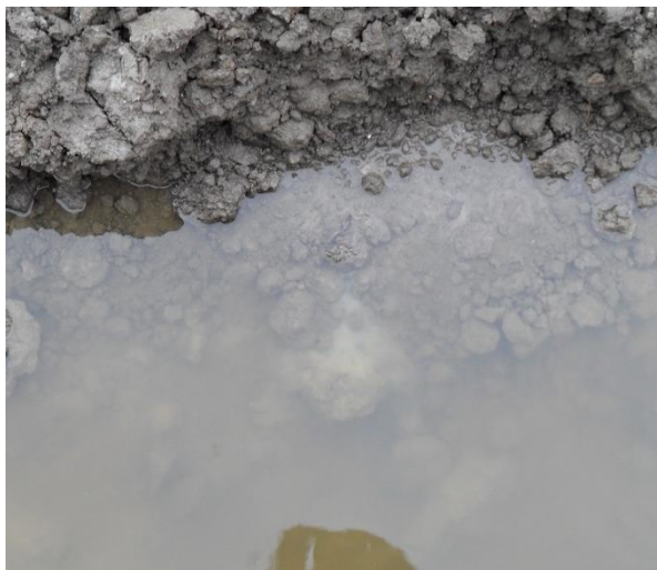
Figuur 4.4 Zandspoortje bij afwezigheid van deklaag
