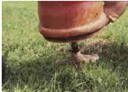
De freeskop heeft een doorsnede van 20 cm en draait met 1000-1800 toeren tot 15 cm diepte
